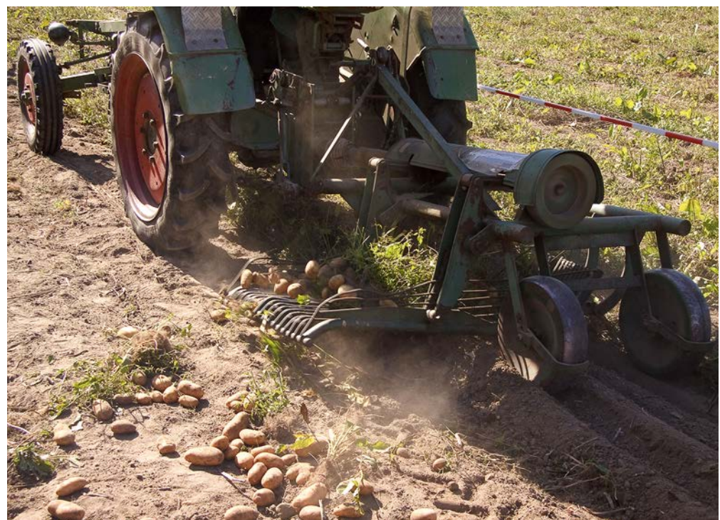
Der Kartoffel-Roder holt die Knollen aus der Erde und schüttelt den Sand ab
